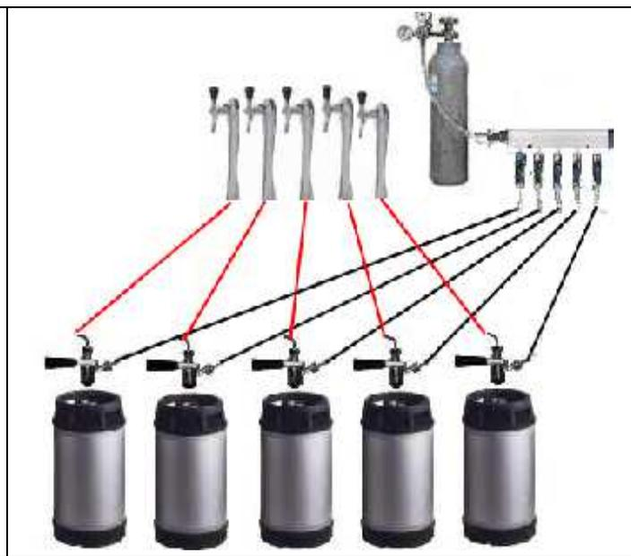
**SCHEMI DI ALCUNI SISTEMI DI SPILLATURA REFRIGERATI**
