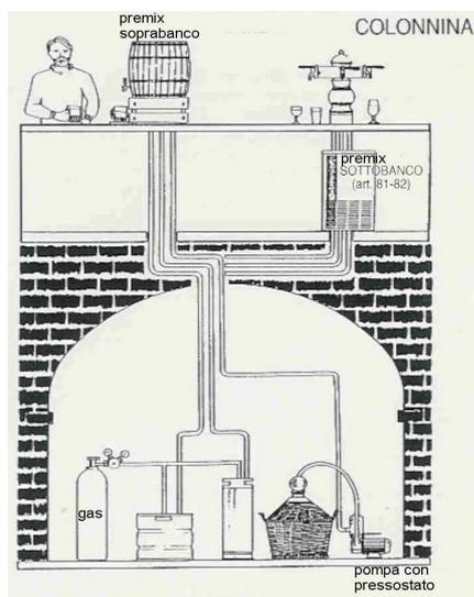
**SCHEMI DI ALCUNI SISTEMI DI SPILLATURA NON REFRIGERATI**
