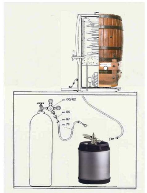
Da damigiane con pompe a pressostato + impianto azoto
